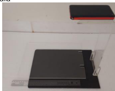
Figura 1. Estrutura de acrílico com fundo para fotografia
