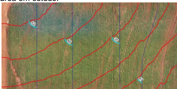
Figura 3 – Cotas em nível calculada (CNC-linhas vermelhas) e linhas de plantio (LP-linhas roxas) na área em estudo.
