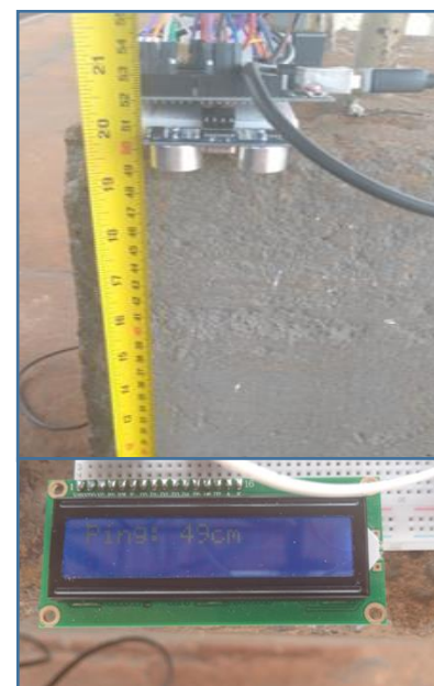
Imagem 4. Aferimento em área concretada
