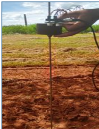
Imagem 1. Sistema Eletrônico Acoplado a Penetrômetro
